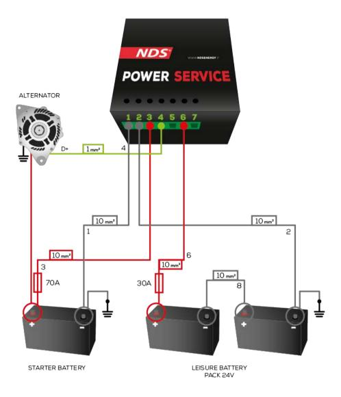
FOR CABLES LONGER THAN 2 METERS USE 16mm<sup>2</sup> CABLES
